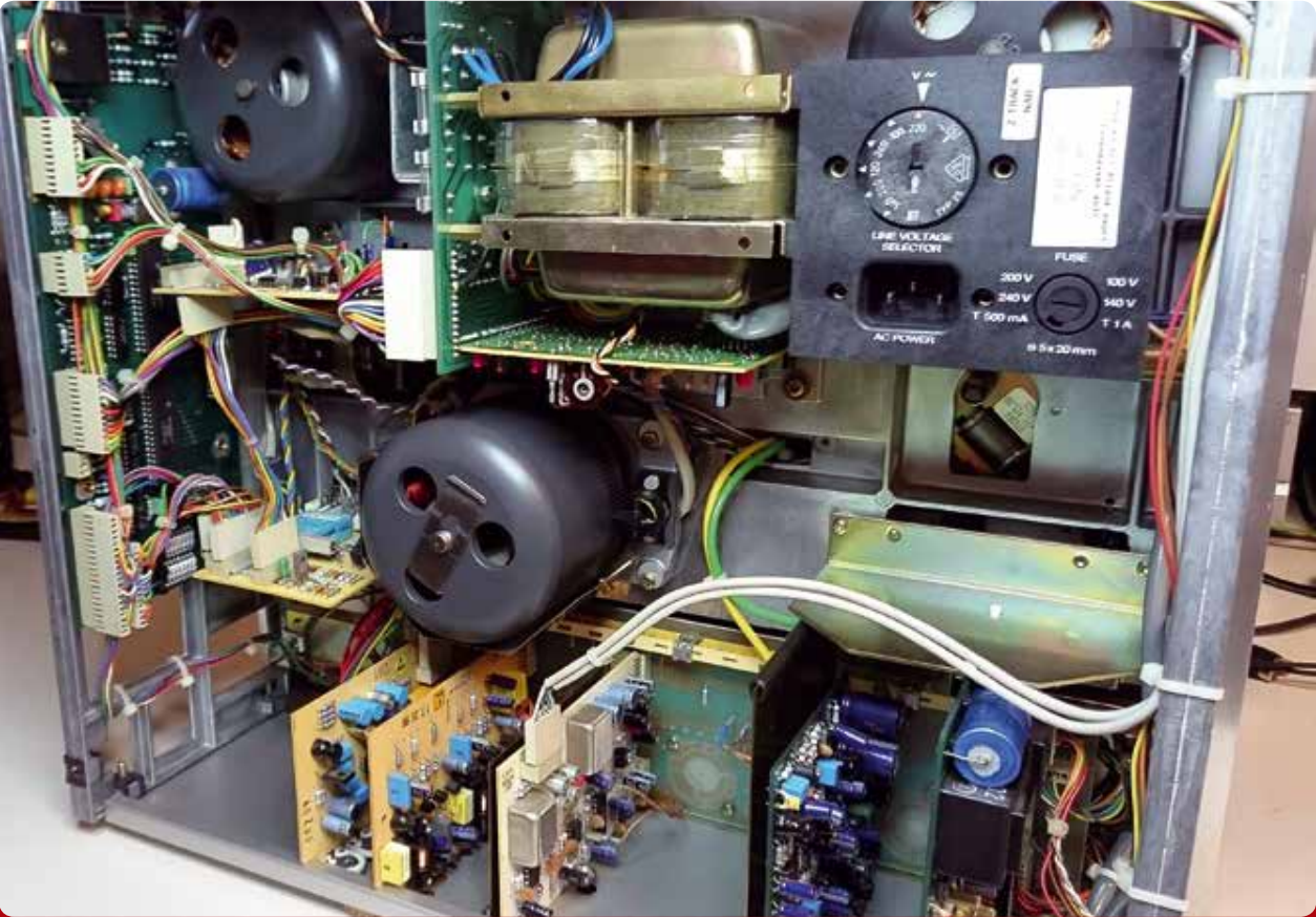
DE REVOX PR99 MK3 IN DE EINDFASE VAN REVISIE BIJ AUDIOSURVIVORS IN NIEUWEGEIN. DIT BEELD LAAT ZIEN WAAROM DEZE MACHINE ZO SERVICEVRIENDELIJK IS. GEBOUWD BINNEN EEN DEGELIJK METALEN FRAME KUN JE OVERAL GEMAKKELIJK BIJ. DE DRIE PAPST DIRECT DRIVE MOTOREN ZIJN VOOR DE EEUWIGHEID GEBOUWD EN BEVATTEN EEN PRODUCTIEDATUM, WAARDOOR GOED IN TE SCHATTEN IS IN WELK JAAR DE RECORDER IS GEMAAKT.
